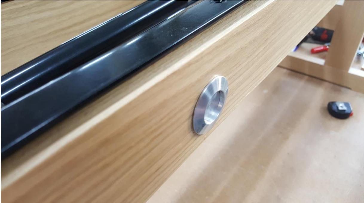
Die Verstellmechanik in Zarge des Gestells einsetzen und festschrauben.
